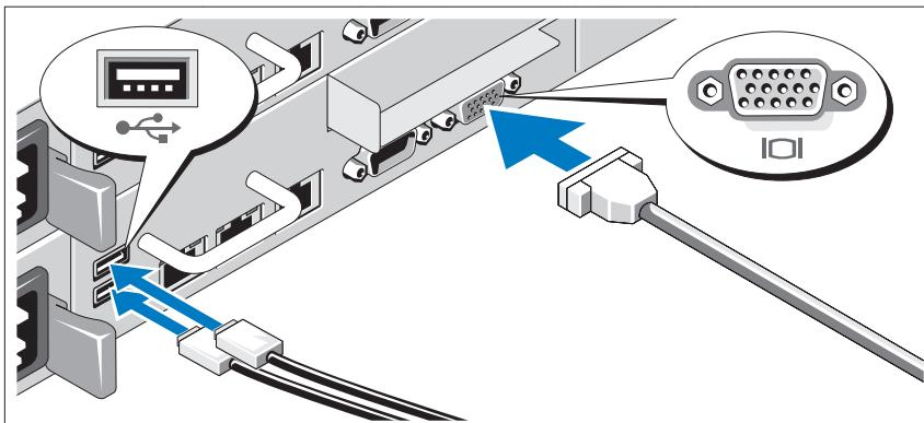
Подключите клавиатуру, мышь и монитор (дополнительно).
