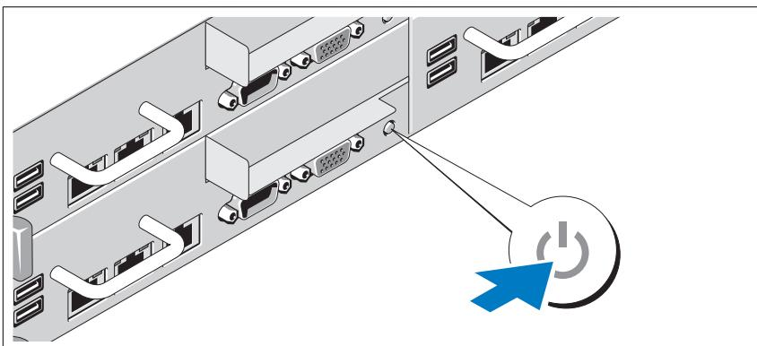
Drücken Sie den Netzschalter an der Vorder- oder Hinterseite des Systems und am Bildschirm. Die Betriebsanzeigen sollten aufleuchten.
