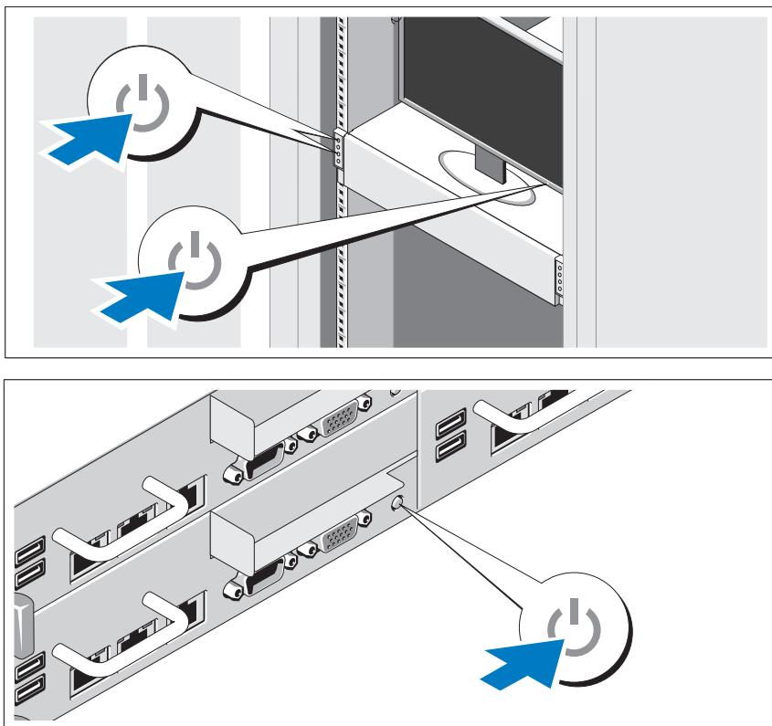
Нажмите кнопку питания на передней или задней панели системы и на мониторе.
