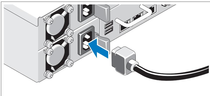
Connectez le ou les câbles d'alimentation au système et, si vous utilisez un moniteur, connectez son câble d'alimentation. Branchez ensuite l'autre extrémité des câbles d'alimentation sur une prise de courant mise à la terre ou sur une source d'alimentation autonome (onduleur [UPS] ou unité de distribution de l'alimentation [PDU]).
