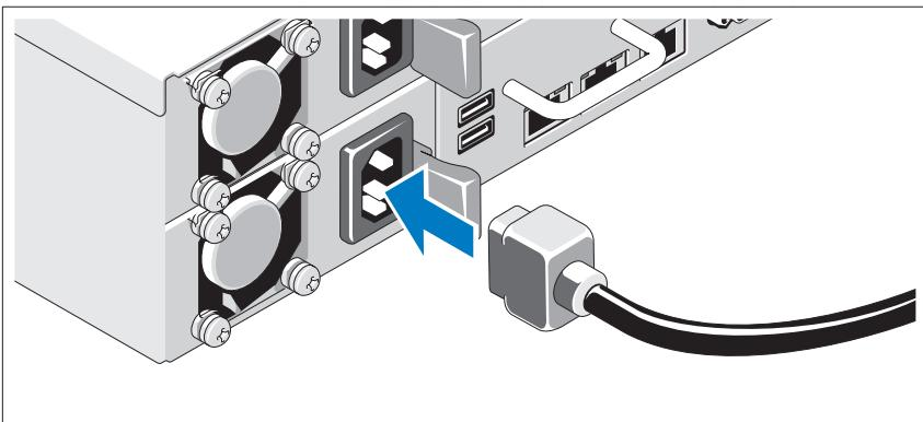
Podłącz odpowiednie kable zasilania do systemu oraz do monitora, o ile używasz monitora. Podłącz drugą końcówkę kabli zasilania do uziemionego gniazdka elektrycznego lub oddzielnego źródła zasilania, np. do zasilania bezprzerwowego (UPS) lub do jednostki rozdziału zasilania (PDU).
