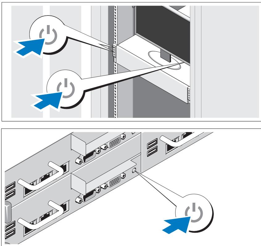
Pulse el botón de encendido de la parte frontal o posterior del sistema y el monitor. Los indicadores de alimentación deberían iluminarse.
