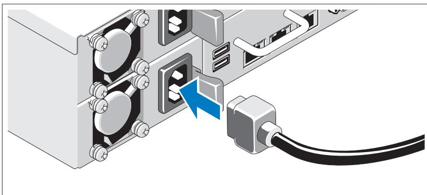
Připojte napájecí kabely k systému, a pokud používáte monitor, připojte napájecí kabel také k monitoru. Poté zasuňte druhý konec napájecích kabelů do uzemněné elektrické zásuvky nebo je připojte k samostatnému zdroji napájení, například ke zdroji nepřerušitelného napájení (UPS) nebo jednotce rozvaděče (PDU).
