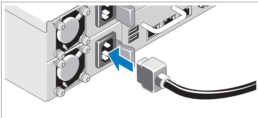
Подключите кабель (кабели) питания к системе. Если используется монитор, также подключите к нему кабель питания. Подключите другой конец кабеля питания к заземленной розетке или отдельному источнику питания, например источнику бесперебойного питания или блоку распределения питания.
