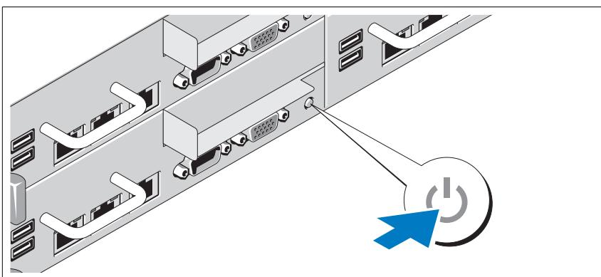
Stiskněte vypínač na předním nebo na zadním panelu systému a na monitoru. Indikátory napájení by se měly rozsvítit.
