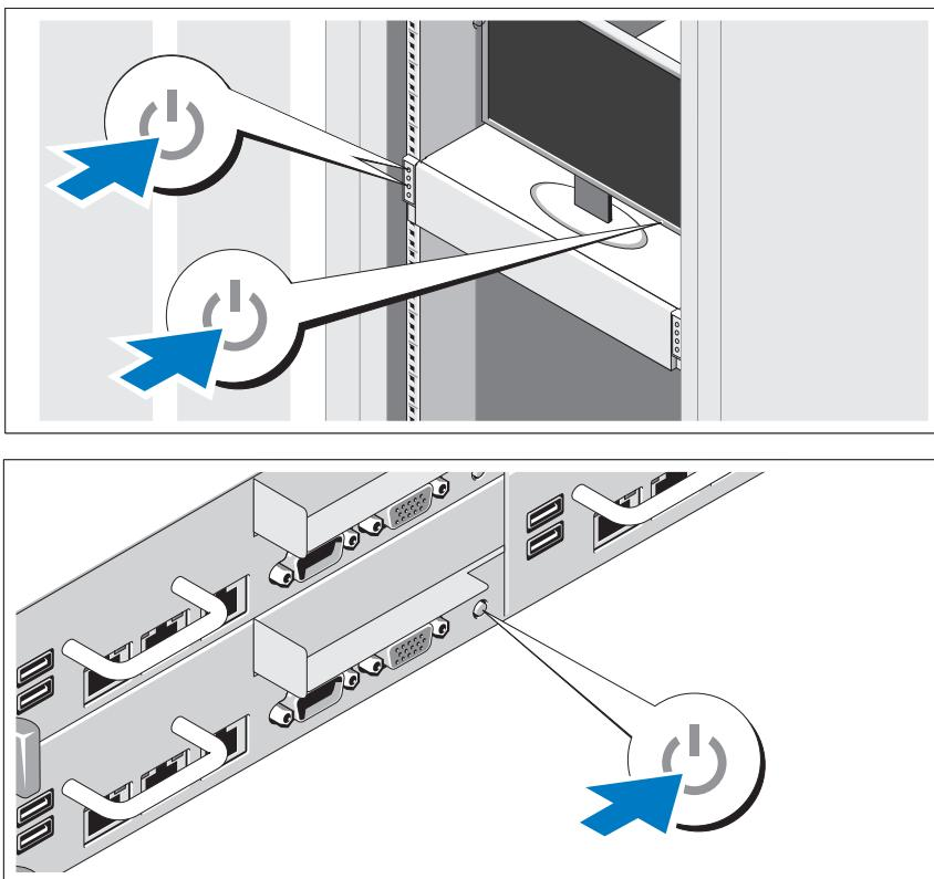
Πατήστε το κουμπί(a) λειτουργίας είτε στο εμπρός είτε στο πίσω μέρος του συστήματος και στην οθόνη. Ανάβουν οι λυχνίες λειτουργίας.
