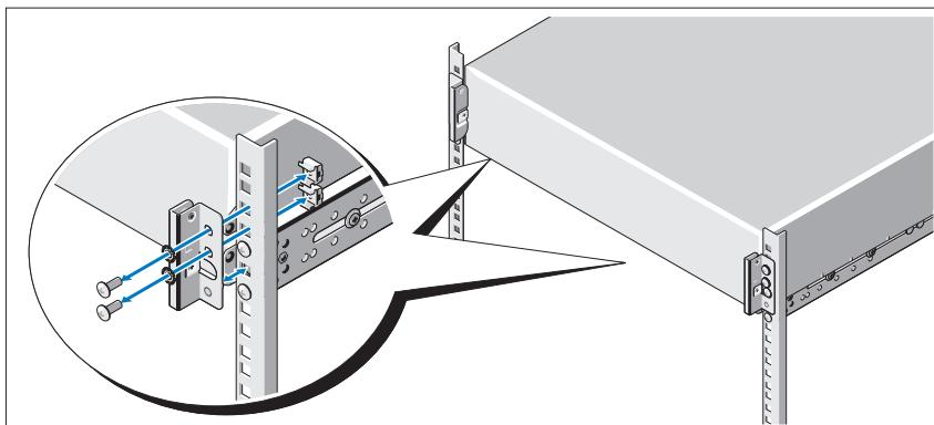
**6** Затяните винты-барашки для крепления проушин системы к стойке.
