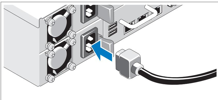
Συνδέστε το(α) καλώδιο(α) τροφοδοσίας του συστήματος στο σύστημα και, εάν χρησιμοποιείτε οθόνη, συνδέστε το καλώδιο τροφοδοσίας της οθόνης στην οθόνη. Βάλτε το φις των καλωδίων ρεύματος σε γειωμένη πρίζα ή ξεχωριστή πηγή ρεύματος όπως π.χ. συσκευή αδιάλειπτης παροχής ρεύματος ή μονάδα διανομής ρεύματος.
