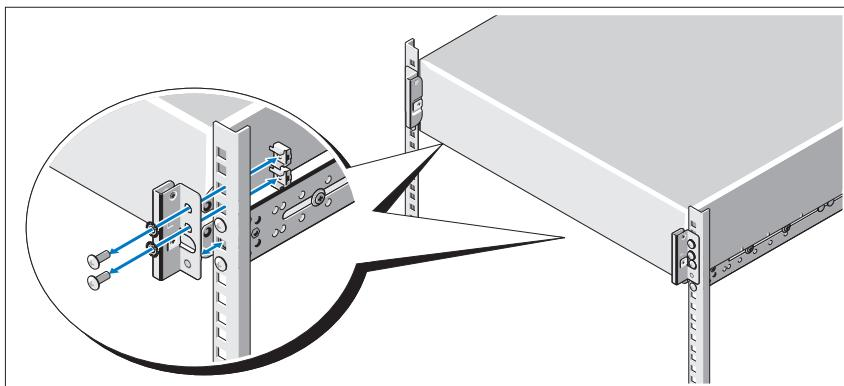
**6** Pomocí šroubků upevněte ouška na systému k přední části stojanu.
