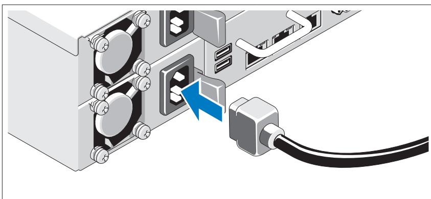
Verbinden Sie die Netzstromkabel mit dem System sowie gegebenenfalls mit dem Bildschirm. Verbinden Sie das andere Ende der Netzstromkabel mit einer geerdeten Steckdose oder einer separaten Spannungsquelle, etwa einer unterbrechungsfreien Stromversorgung oder einem Stromverteiler.
