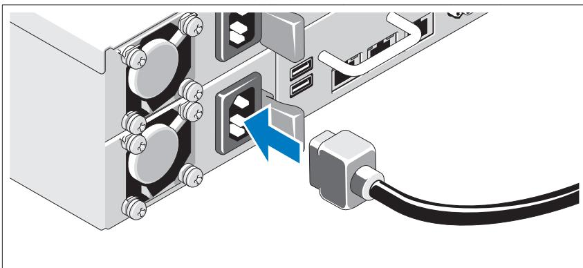
Conecte los cables de alimentación al sistema y, si se utiliza un monitor, conecte el cable de alimentación correspondiente al monitor. Conecte el otro extremo de los cables de alimentación a una toma eléctrica con conexión a tierra o a otra fuente de energía, como por ejemplo un sistema de alimentación ininterrumpida o una unidad de distribución de alimentación.
